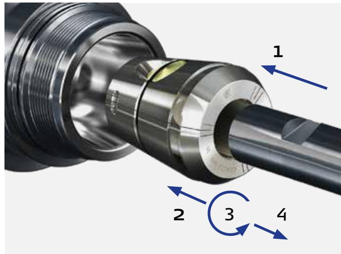
Die Kegeldruckfeder wird in der Aufnahme arretiert. Sie positioniert das Werkzeug von selbst ganz perfekt am Keil
