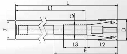
• **Standard:** MPC Hochgenauigkeits-Spannmutter **ohne** Spannüberbrückung. Rundlauf  $\leq 3 \mu\text{m}$  mit Spannzangen GERC-HP.
