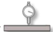
4 µm bei 3xD mit W Spannzangen
