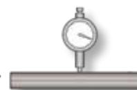
4 µm bel 3xD mit W Spannzangen
