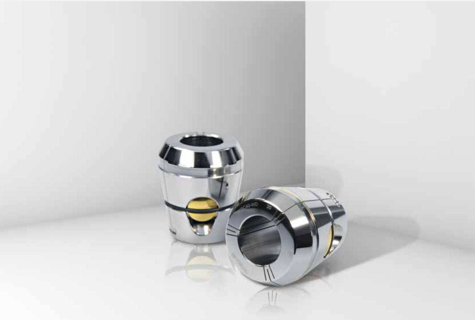
Ab jetzt gilt: kein Auszug oder Mikro-Kriechen des Werkzeugs mehr – zu 100 Prozent. Die Lösung ist so einfach wie genial. Es ist ein integrierter Keil, der an der Weldon-Fläche anliegt. So hat der Anwender die Gewissheit, dass selbst bei Überlastung des Systems aus Fräsmaschine, Spindel, Aufnahme und Werkzeug keine kostspieligen Schäden am Werkstück entstehen.
