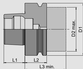
Einsatzmaterial, gehärtet und geschliffen
