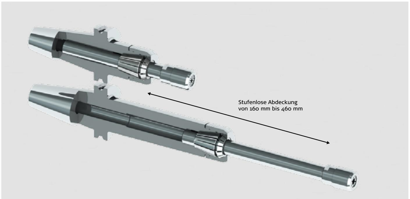
Grundsätzlich wird bei Werkzeugaufnahmen die Dämpfung umso wichtiger, je länger die Auskragung ist. Zusätzliche Schnittstellen (Verlängerung im Basisfutter über Hoch-Präzisions-Spannzange) bedeuten zusätzliche Dämpfung.
