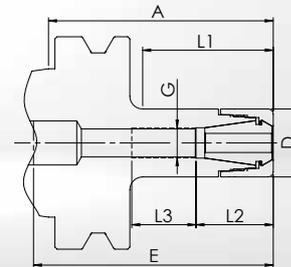
• **Futterkörper und Spannmutter separat gewuchtet**
