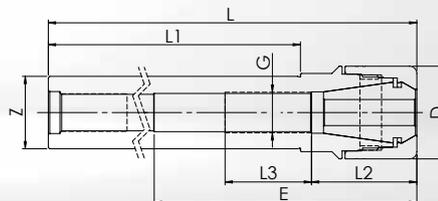
• **Standard:** DPC Hochgenauigkeits-Spannmutter **ohne** Spannüberbrückung. Rundlauf  $\leq 3 \mu\text{m}$  mit Spannzangen GERC-HP.
