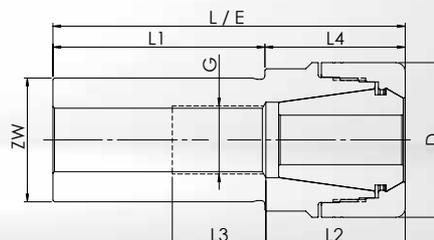
• **Standard:** DPC Hochgenauigkeits-Spannmutter **ohne** Spannüberbrückung. Rundlauf  $\leq 3 \mu\text{m}$  mit Spannzangen GERC-HP.
