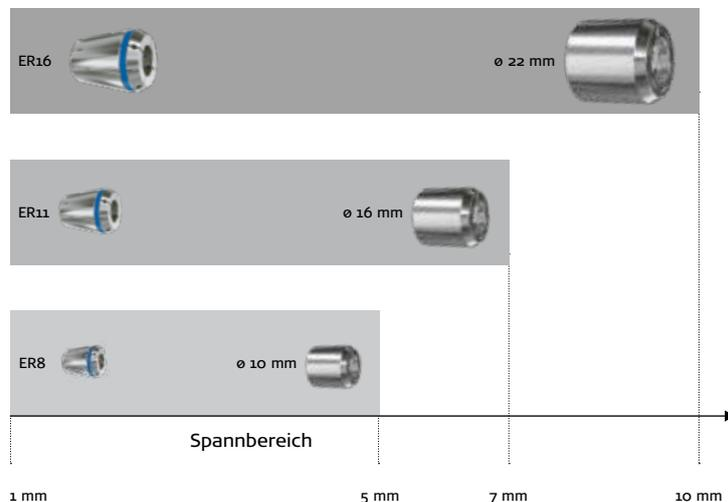
Bereits ab einem Schaftdurchmesser von 1 mm können Zylinderschäfte prozesssicher gespannt werden. Die Außendurchmesser beginnen dabei schon bei 10 mm.
